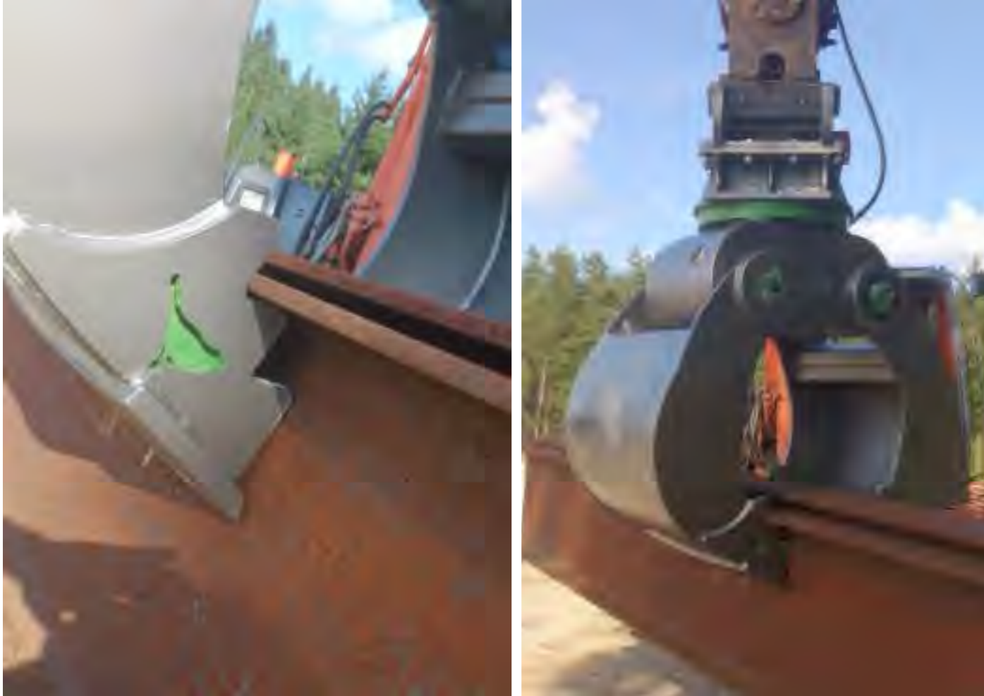
Universelles "BEST-GRIP"-Schalendesign für die zuverlässigste und sicherste Manipulation von Metallprofilen
