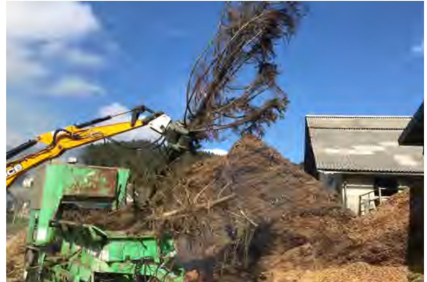
Der "Alligator-Greifer ist ein hervorragendes Werkzeug für den Biomasseumschlag und die Hackschnitzelproduktion
