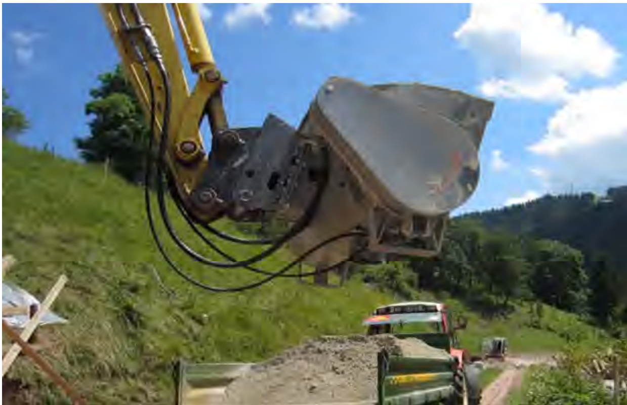
Betonmischschaufel für Aushub 3 bis 10t Betriebsgewicht (MMB 200 und MMB 250). Geeignet zum Befüllen mit Sand von einem Traktoranhänger für Bereiche mit begrenztem Platzangebot
