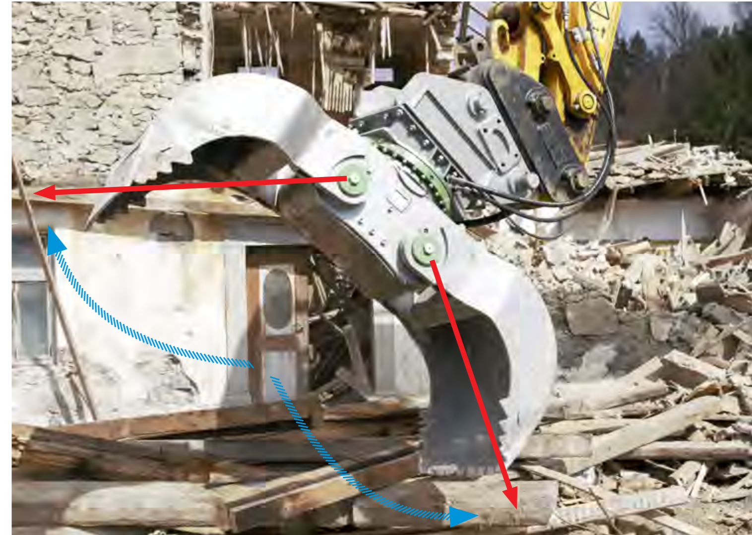
Breiter Grifföffnungswinkel - viel größerer Greifbereich durch den „Best Grip“ Greifer
