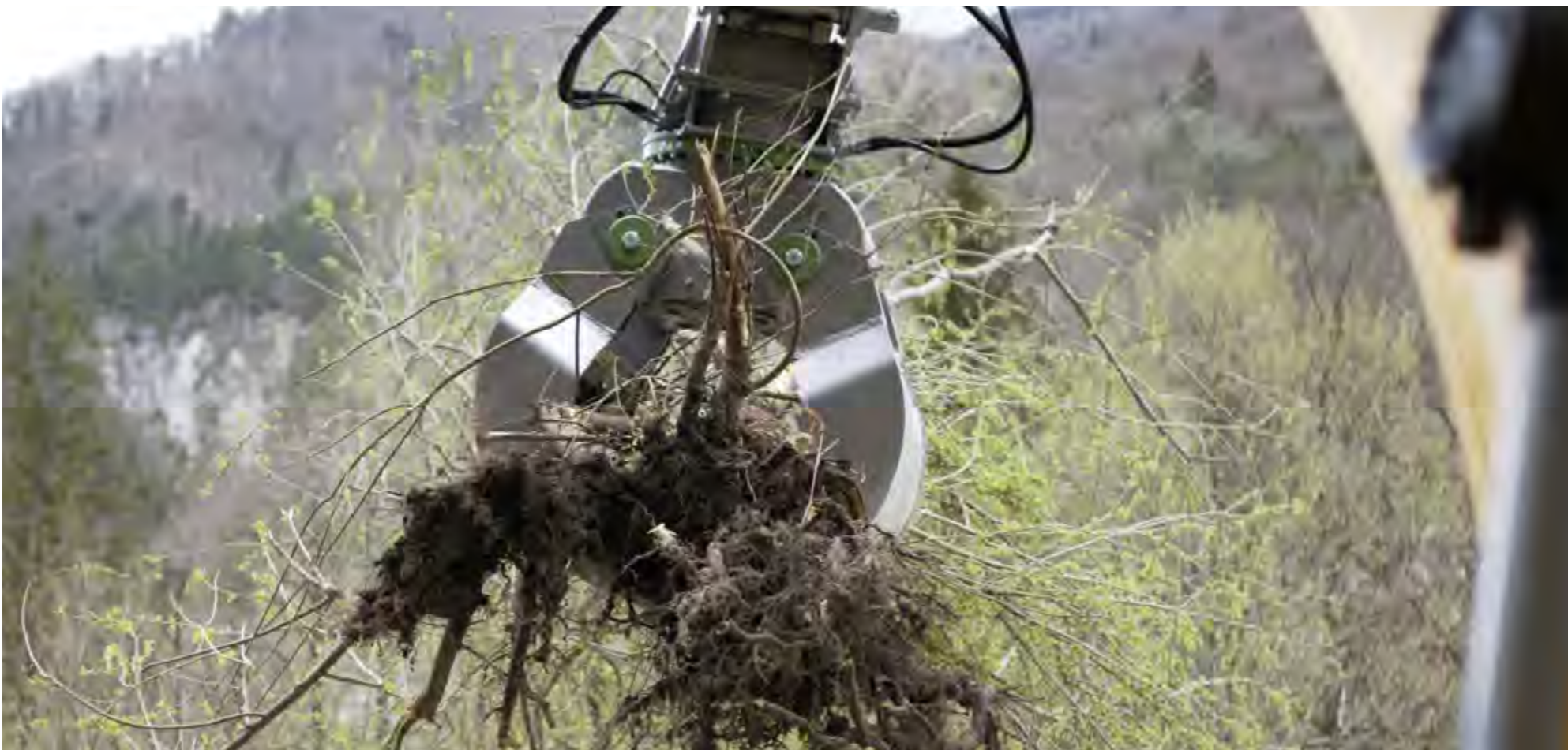
Rodung von Sträuchern und Entwurzelung von Bäumen mit Best Grip Greiferschalen
