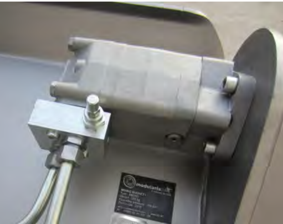
Entlastungshydraulikventil am Hydromotor schützt den Antrieb und erhöht die Lebensdauer installiert bei 170 bar max. Betriebsdruck
