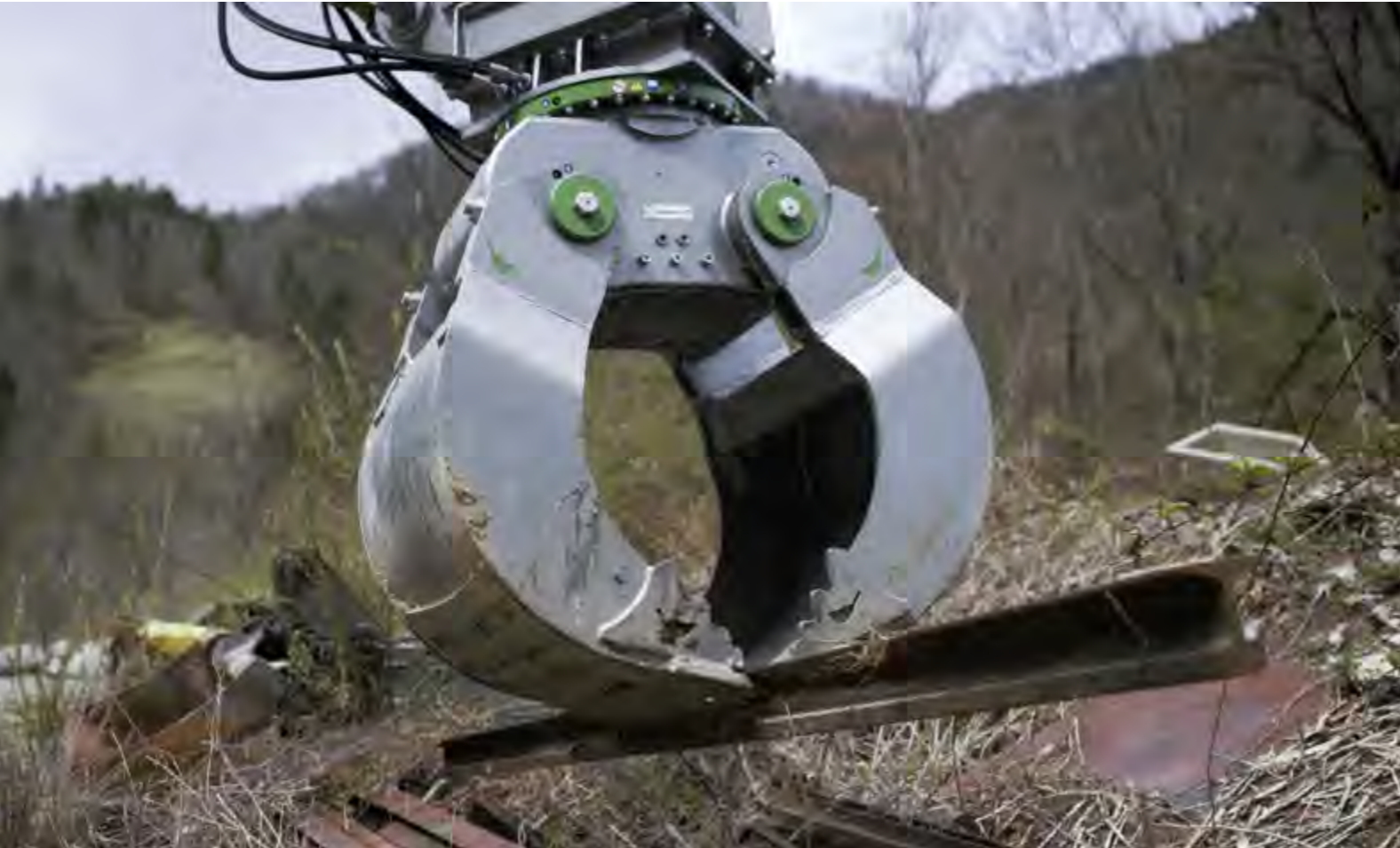
Stahlprofil-Handling mit universellem Best-Grip-Design
