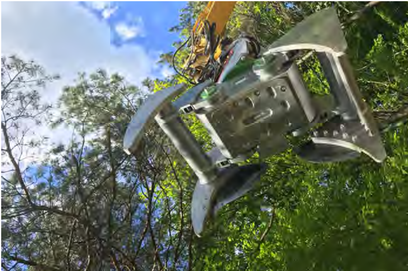
Ein flexibles Werkzeug zum Schneiden von Bäumen in allen Positionen
