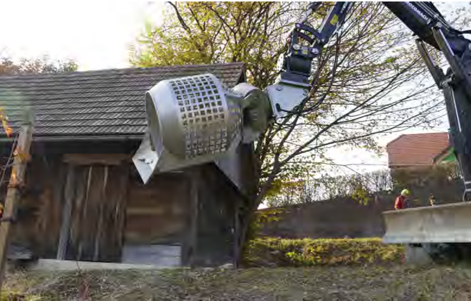
Siebtrommel zum Sortieren von Natur- und Baumaterialien - für eine saubere und aufgeräumte natürliche Umgebung
