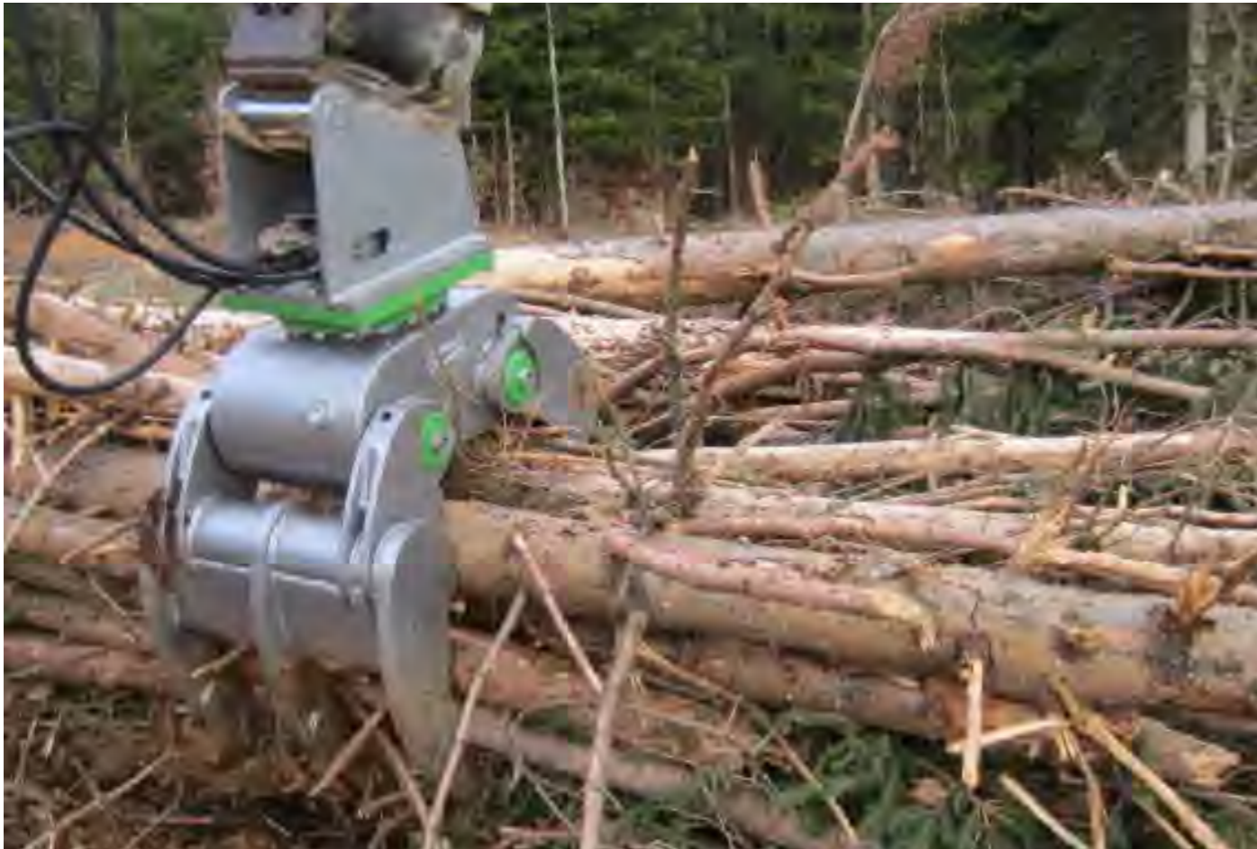
Biomasse-, Holz- und Rundholzmanipulation mit dem Modularis "Alligator" Schalendesign. Kann als Holz- und Stammholzgreifer verwendet werden
