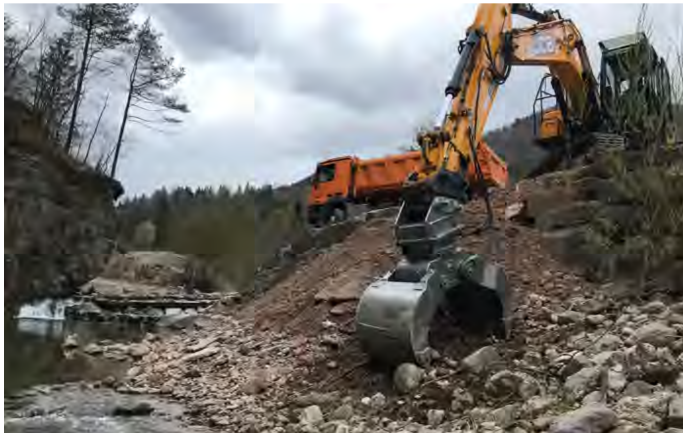
Universalgreifer mit leakagefreiem Antrieb und "Best Grip"-Backen für die Reinigung von Flussufern
