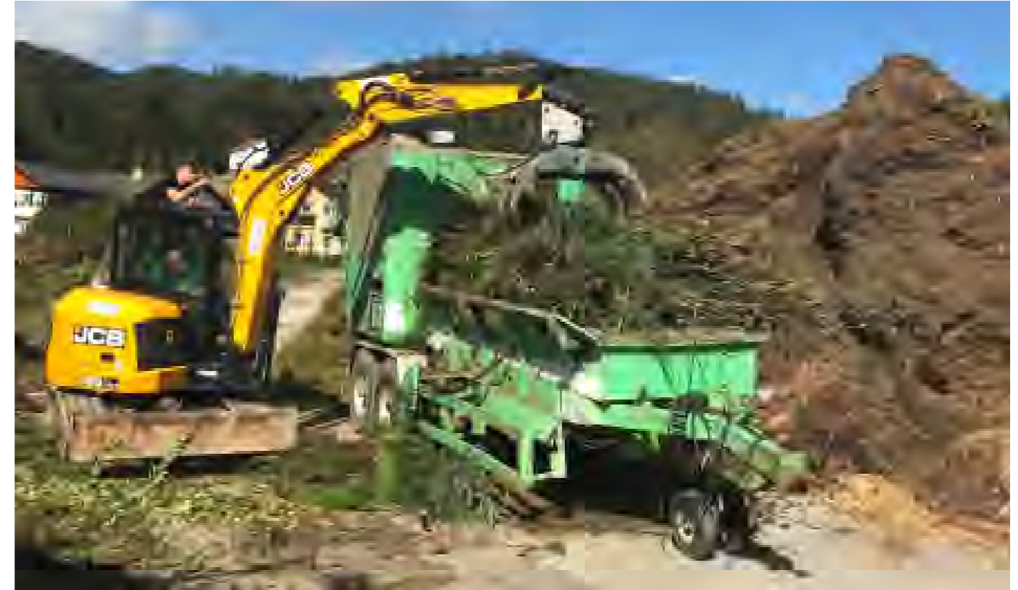
Der "Alligator-Greifer ist ein hervorragendes Werkzeug für den Biomasseumschlag und die Hackschnitzelproduktion
