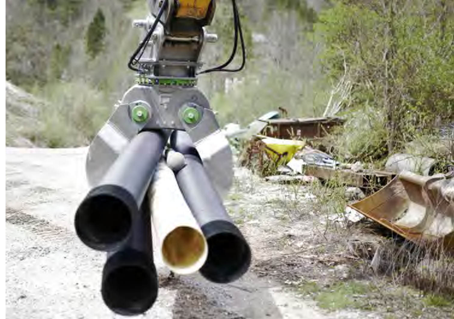
Handling von PVC-Rohren mit universellem Best-Grip-Design
