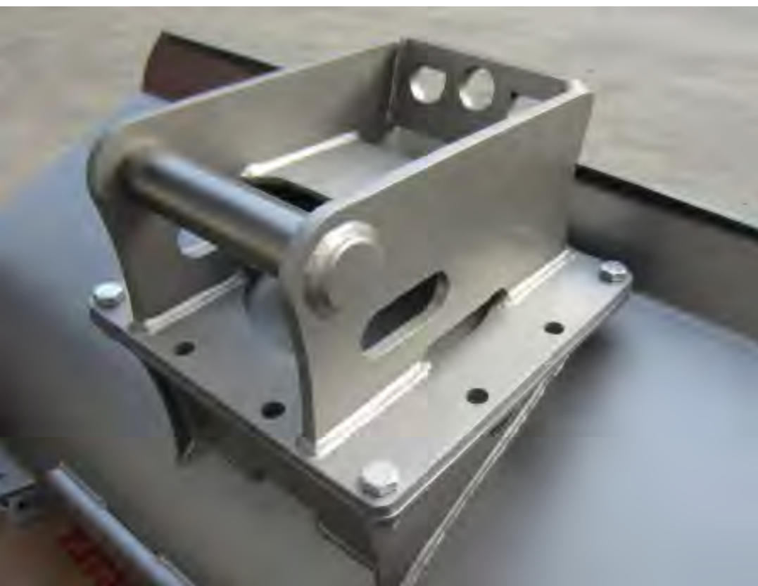
Austauschbare Anschlussplatte für alle Baggeranschlussarten Die Anschlussplatte kann um 180 Grad gedreht werden Es gibt zwei Anschlussmöglichkeiten: Der Mischschaufel ist dem Bediener zugewandt (der Betonmischvorgang, für geringere Hubhöhen) Der Mischschaufel ist vom Bediener abgewandt für größere Hubhöhen und Entleerung des Betons
