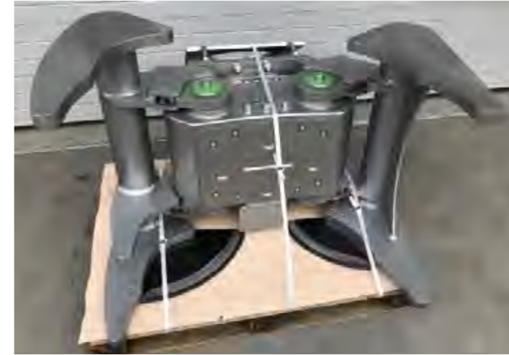
Baumschere. Nicht rotierender Antrieb, Rototilt Version
