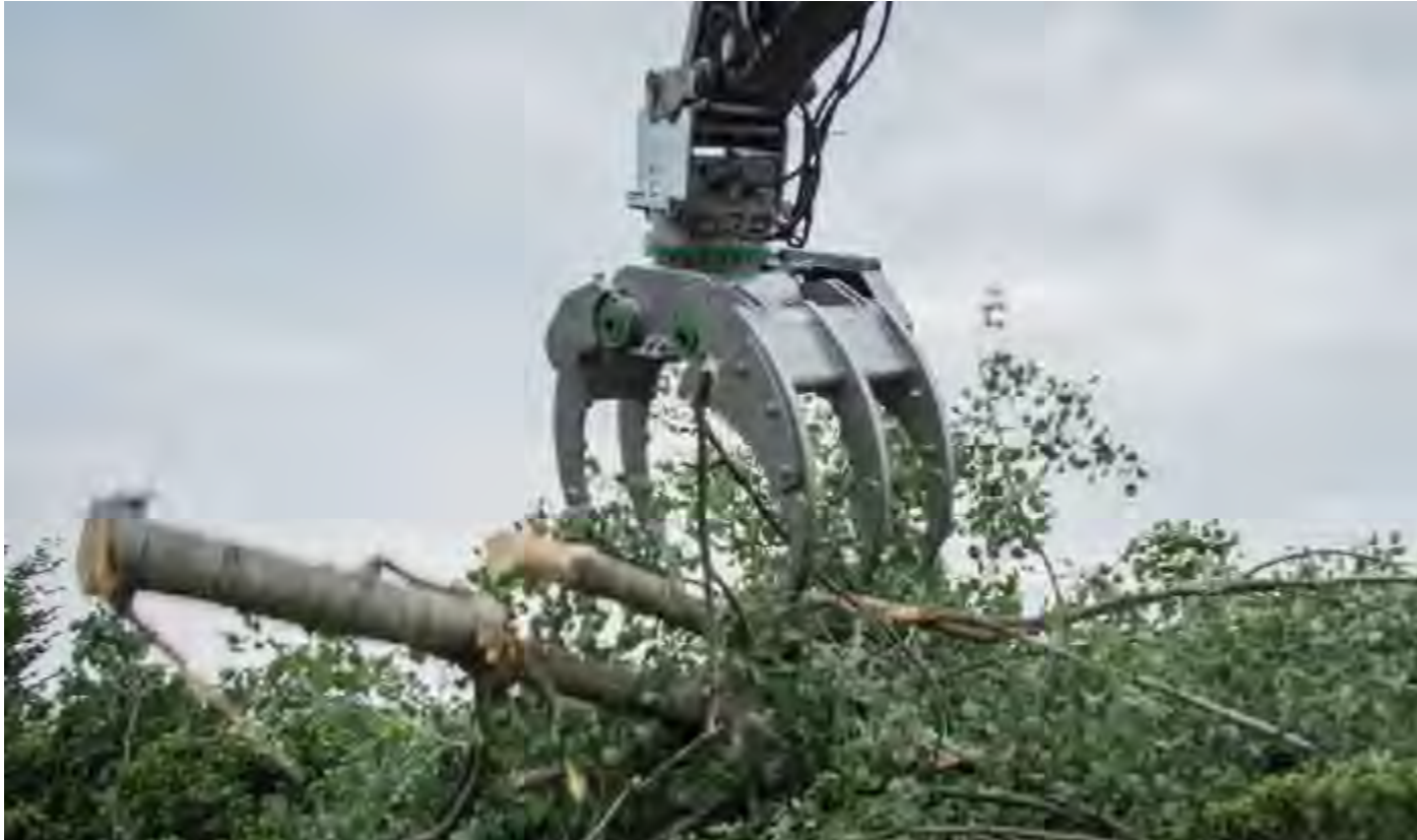
Biomasse-, Holz- und Rundholzmanipulation mit dem Modularis "Alligator" Schalendesign. Kann als Holz- und Stammholzgreifer verwendet werden
