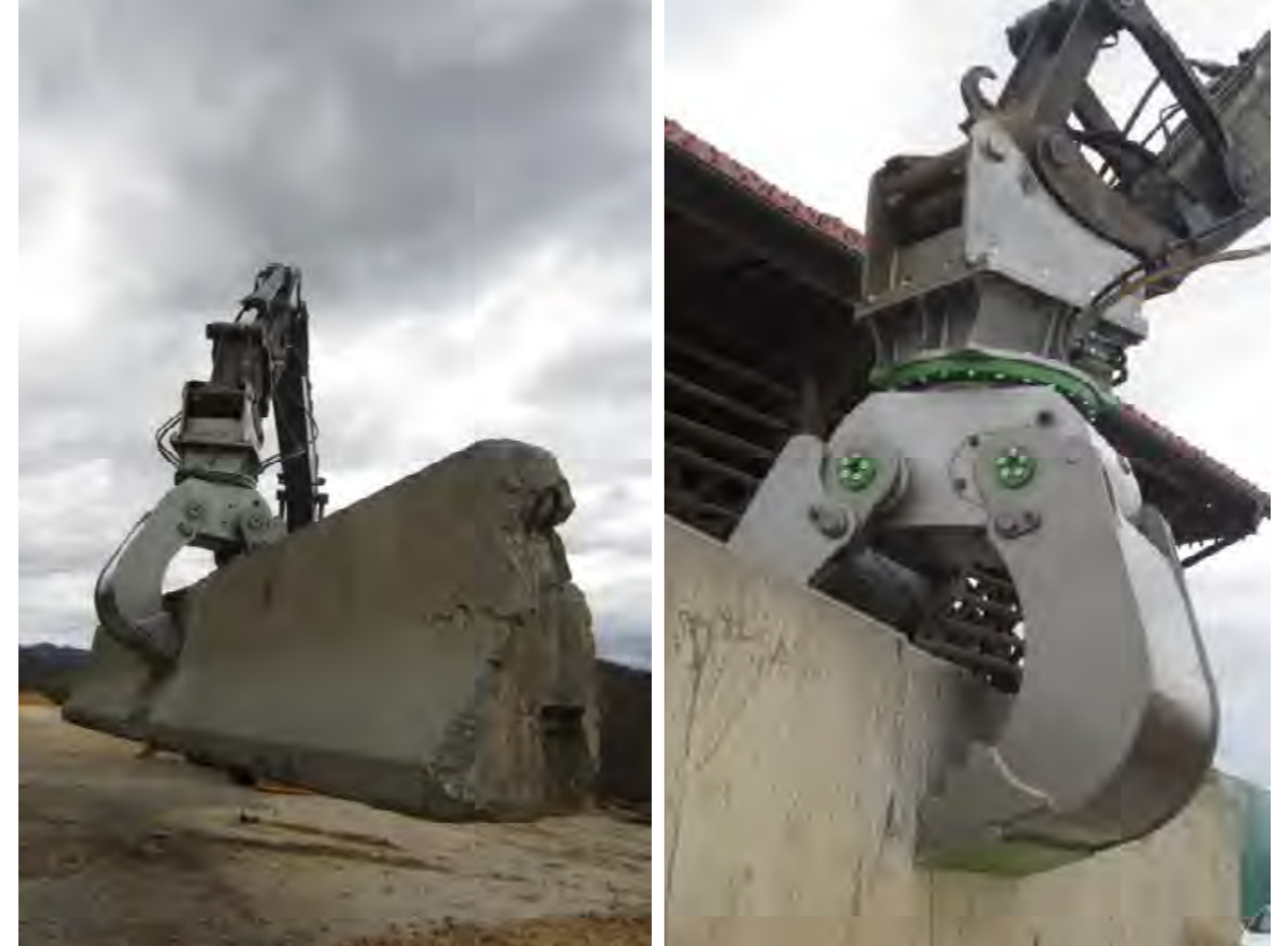
Der Greifer verfügt über einen starken Drehmoment mit zusätzlichen Hydromotoren und Bremsen.
