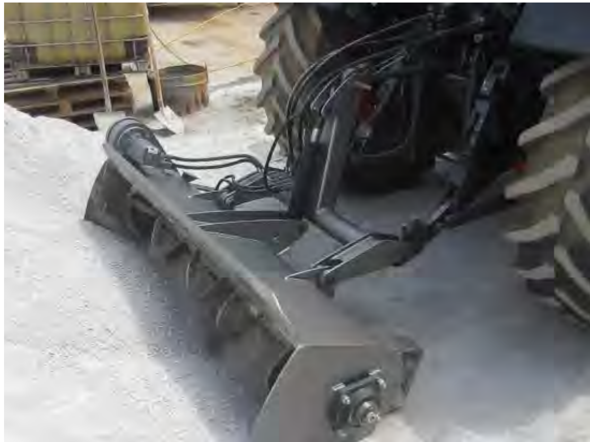
Dreipunkt-Kippmechanismus für einfache Sandbefüllung
