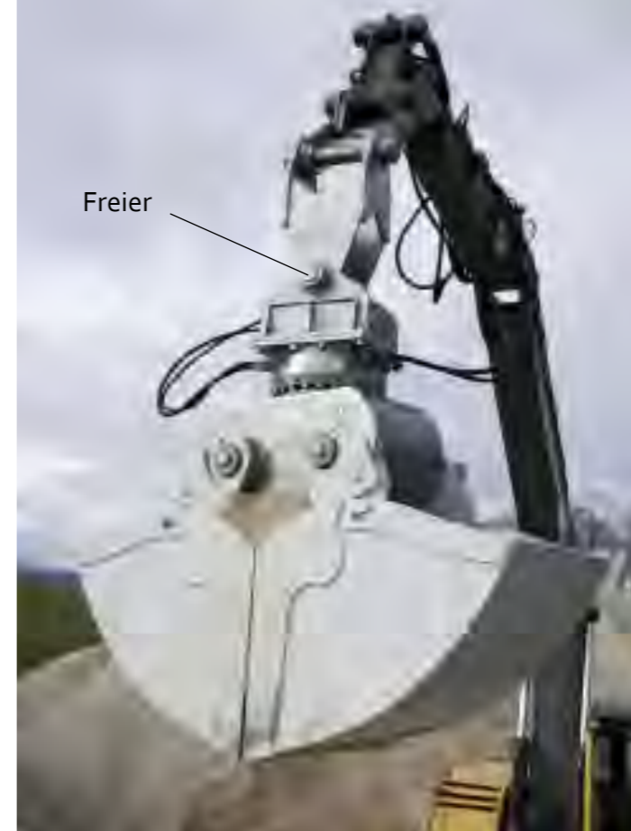
Material-Handler-Version: Modell MD12.0 – MD25.0 C-MH mit Rotationsantrieb & freiem Link
